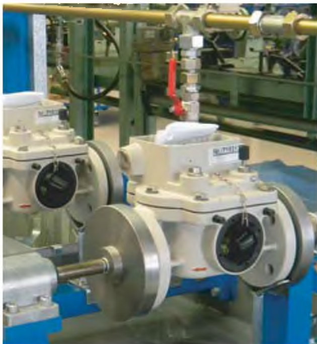
Рис. 6 - Испытание работоспособности и герметичности
