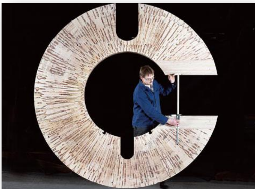
Рис. 3.4-1 Прессующее кольцо из букового древесно-слоистого пластика тангенциальной структуры [13]
