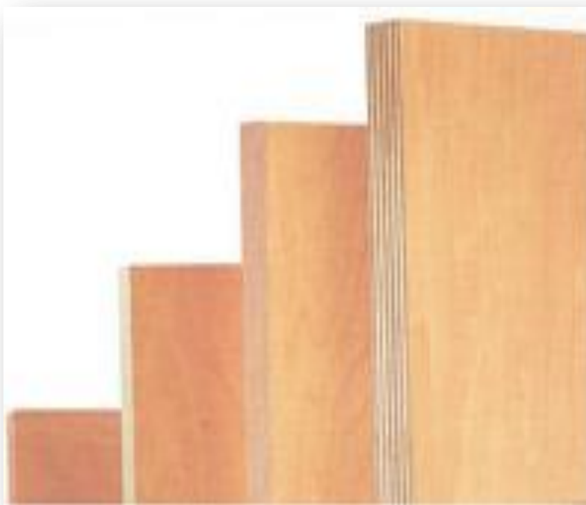
Рис. 2.3 Электроизоляционный древесно-слоистый пластик на основе шпона красного бука, преимущество которого заключается в высокоорганизованной структуре параллельных капилляров, проходящих через всю плиту.
