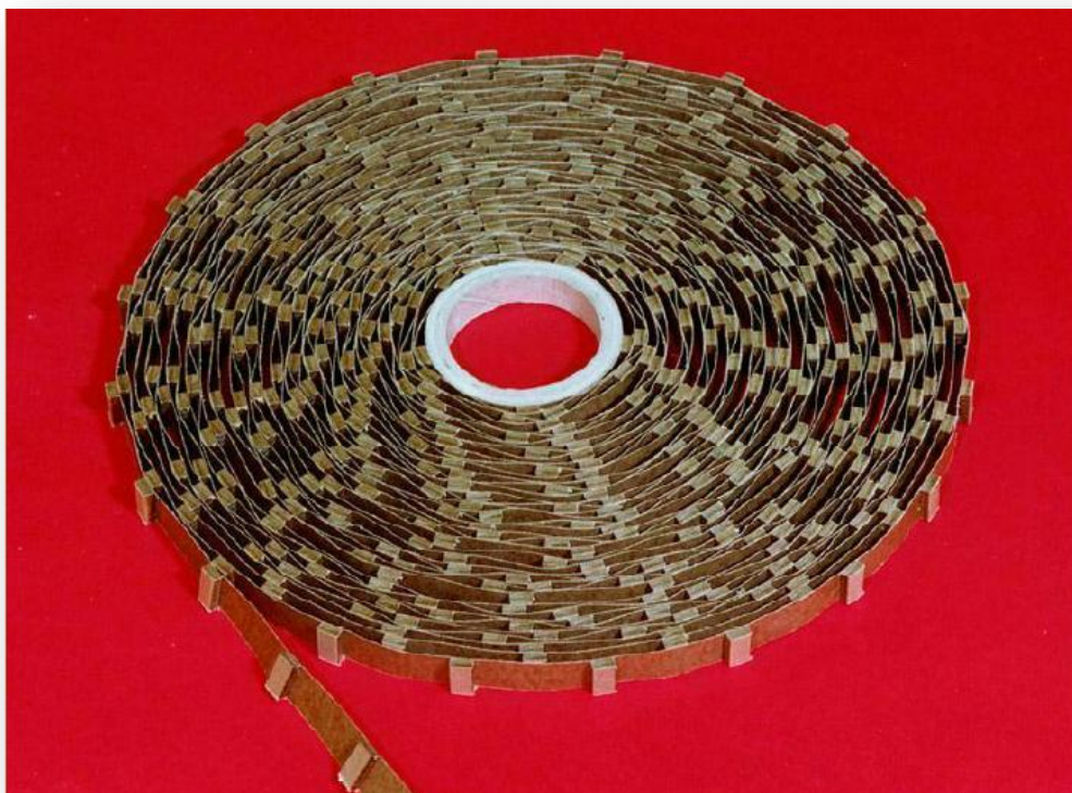
Рис. 3.12-1 Лента с дистанцирующими блоками для создания каналов охлаждения при намотке катушек транспонированным проводом [2]
