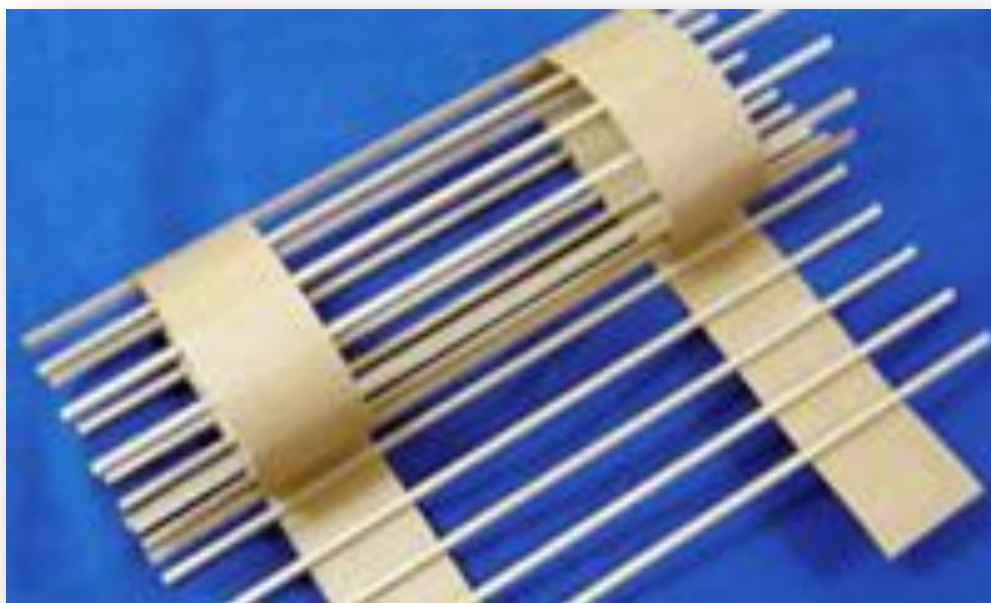
Рис. 3.12-2 Рулон дистанцирующих реек, базированных на двух бумажных лентах, для создания каналов охлаждения распределительных трансформаторов [11]
